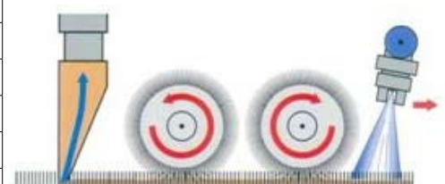
Sproei-extractie reiniging met NS400BR HT
