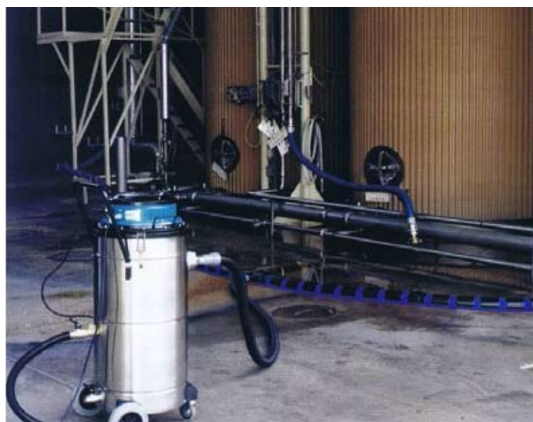
De Dam in gebruik in combinatie met de 204L waterzuiger met afvoerpomp. Tegelijkertijd opvangen en afvoeren!
